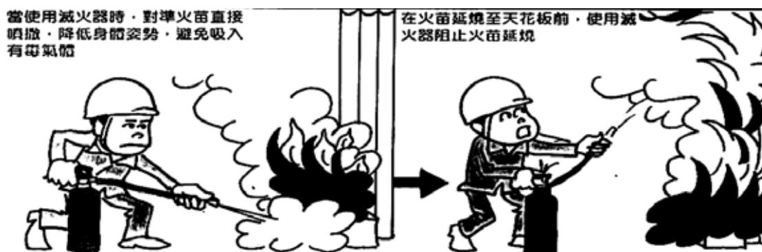
圖 3-10 滅火器操作方法
